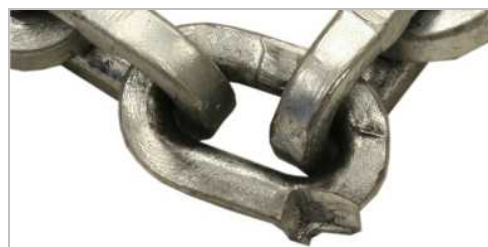
Kædeleddet er mekanisk beskadiget.
